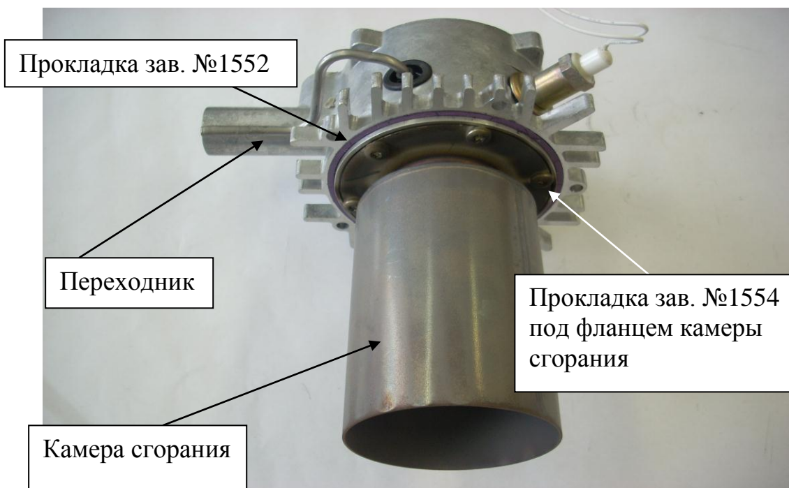
Рис. 10б – Камера сгорания с переходником в сборе
